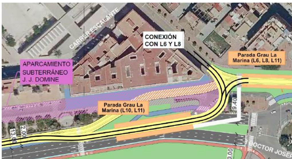
Figura 5. Ejemplo de posible conexión del nuevo trazado hacia la calle Francisco Cubells, con un andén nuevo de parada para permitir el transbordo en Grau La Marina con las líneas que continúan hacia Neptú.
